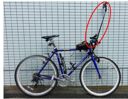
図 1: 自転車にスマートフォンを搭載した様子。赤丸部分が本システムで制作したマウントである。カメラ用自撮り棒と自転車用のマウント等を組み合わせて制作した。
