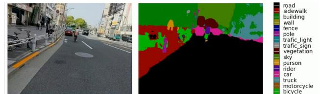
図 21: 車道と歩道の上に低い柵があるシーンの例。危険な道路端と認識される。
