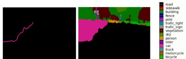
図 8: Deeplab の結果 (右図) とそのうち自動車のピクセルのうち道路と隣り合っているピクセル (左図) を表示している。入力画像は図 7 の画像である。
