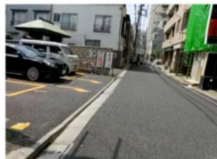
図 18: 自動車が左側に存在すると認識されていないシーンの例。左側の駐車場に自動車が駐車されている。
