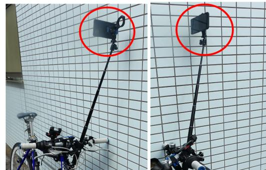
図 2: 自転車にスマートフォンを搭載するためのマウント。赤丸部分にスマートフォンを装着する。スマートフォンの内側カメラで運転者の顔を、外側カメラで自転車の正面の道路状況を捉える。
