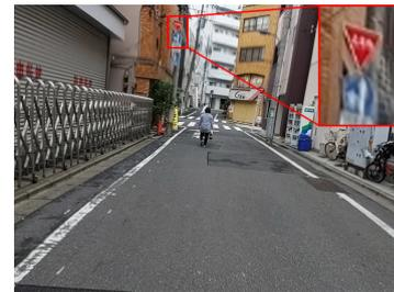
図 12: 実際に一時停止標識が存在するが、本プロトタイプで一時停止標識の存在が認識されなかったシーン。画像中央上部に一時停止標識があり、右上を拡大画像に表示している。図 10 と比較して一時停止標識の位置が高く、振動によりぼやけている。
