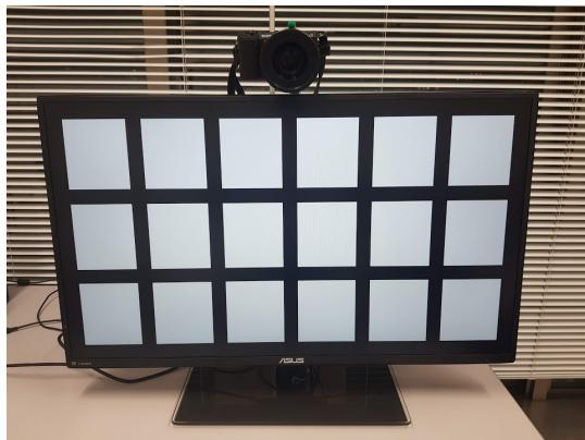
図 2: 提案するシステムのハードウェアの構成。本システムは、高画質カメラ、液晶ディスプレイモニター、NVIDIA の GPU を搭載した PC から構成される。カメラはモニターの上部に設置し、USB ケーブルで PC に接続してある。カメラは PC から操作可能であり、撮影した画像を PC に転送することができる。モニターには、目の乾燥状態を判別するために目に映すグリッドパターンの画像を表示する。
