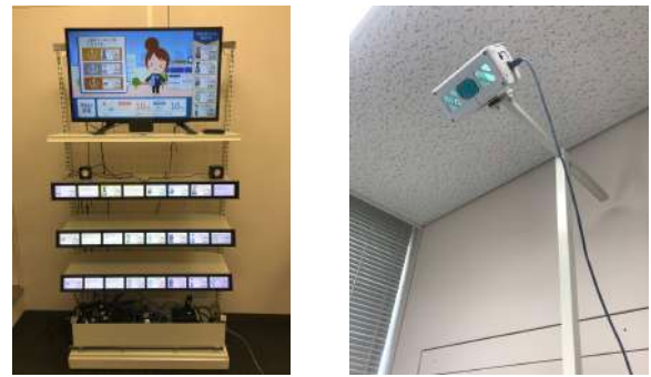
(a) インテリジェント・ラベル™ (b) 行動データを取得するための を正面から見た様子。 ToFセンサー。
