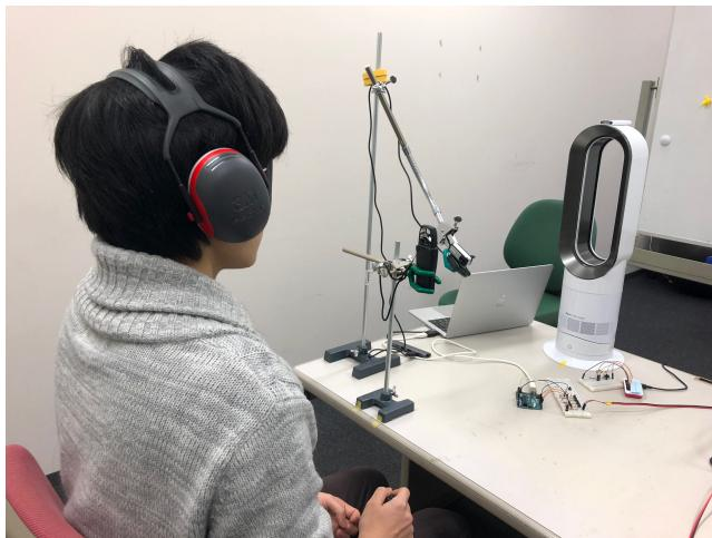
図 4: 実験の様子. 扇風機と風速計が設置され, 実験参加者がボタンを持って座席に着座している. 実験参加者は, 視覚と聴覚の影響を可能な限り排除するため目隠しとイヤーマフを装着している. 座席の位置は, 扇風機の真正面かつ座席を回転させたとき背もたれが机に触れる位置に固定してある. 背もたれは固定され, 風を当てる体の部位を変えるために回転できるようになっている. 風速計は, 扇風機と実験参加者を結ぶ直線上で, 体に当たる直前の風の風速が計測できるように実験参加者の直前に設置されている.
