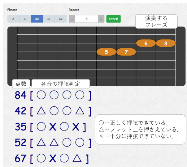
図2: 作成したシステム. 指定したフレーズ (4 音) を弾くと, その演奏の点数と各音の押弦の適切さを判定する. この図は, 指定したフレーズを 5 回繰り返して演奏したときの結果を表している.
